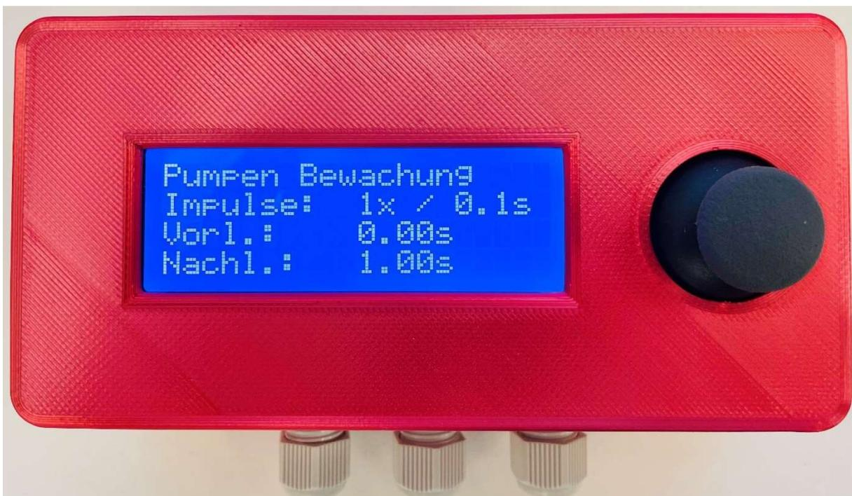
Abbildung 6: Pumpeninformationen, die auf dem Anzeigebildschirm 2 verfügbar sind
