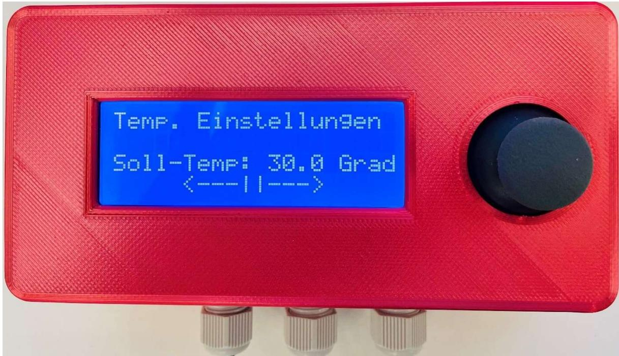
Abbildung 7 Der Benutzer kann die gewünschte Temperatur mit der Joystick-Taste einstellen
